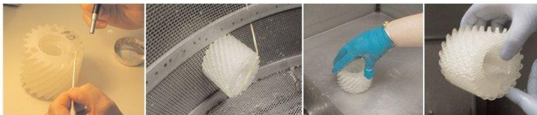
Рисунок 3.15 - Постобработка выжигаемых моделей
