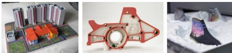
Рисунок 5.1 - Изделия, полученные методом CJP
