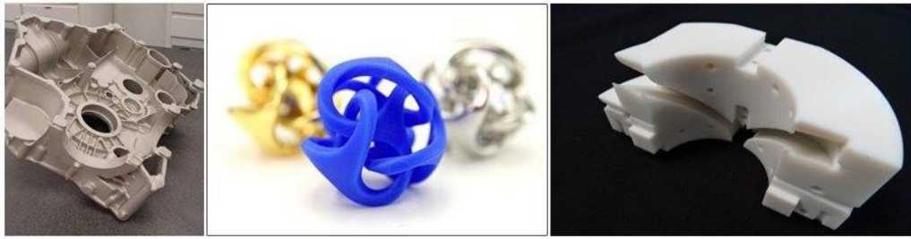
Рисунок 3.2 - Примеры изделий, изготовленных на SLA-машинах
