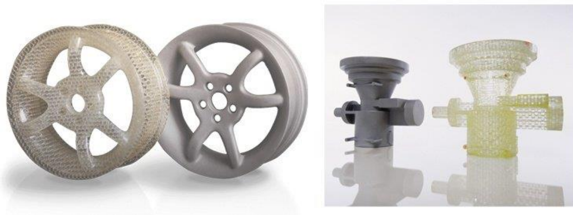
Рисунок 3.13 - Литейные модели, изготовленные по технологии QuickCast
