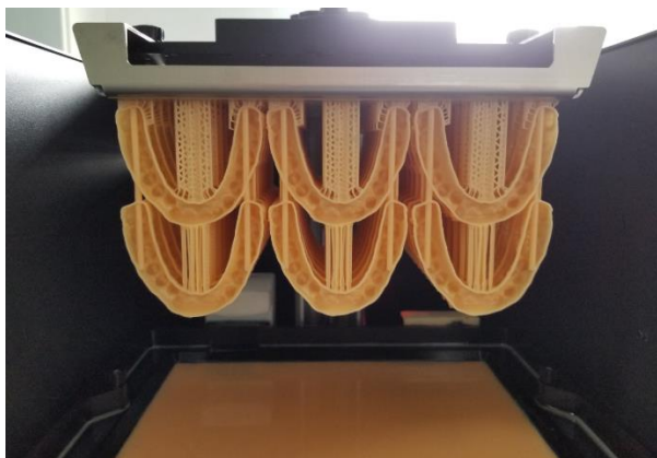
Рисунок 3.6 - Печать изделий для стоматологии на LCD-принтере
