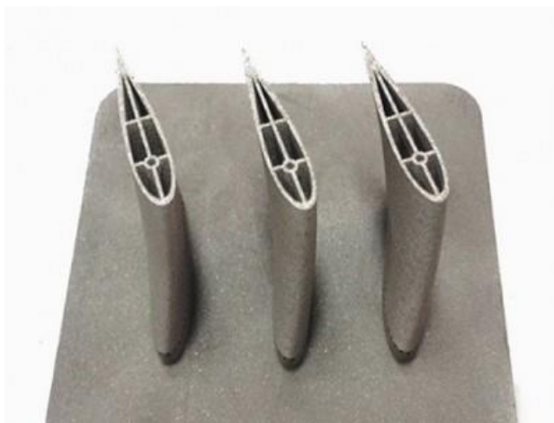
Рисунок 8.11 – Сечения лопатки турбины газотурбинного двигателя
